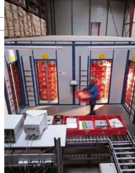
Das Horizontalkarussell in der Lagerlogistik und im Fulfilment
